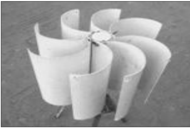
Fig 21: Mini Savonius wind turbine rotor
