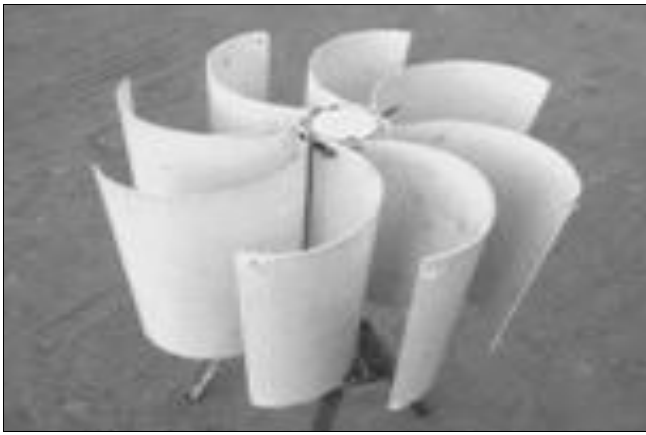
Fig 21: Mini Savonius wind turbine rotor
